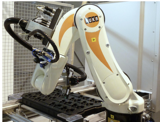
Roboter A – Manipulation mit Teilen in der Stifungpalette
