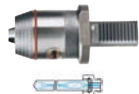
Dichtscheibe WTE 13 \phi 4,2 mm im Bohrfutterkopf eingebaut, für Kühlkanalbohrer \phi 6-13 mm mit glattem Schaft nach DIN 6535 Form HA.
