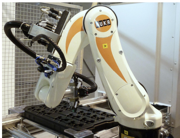
Робот А – манипуляция с частями в паллете загрузки
